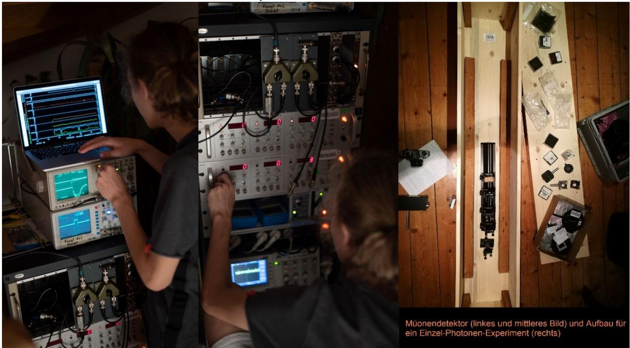
Müonendetektor (linkes und mittleres Bild) und Aufbau für ein Einzel-Photonen-Experiment (rechts)
